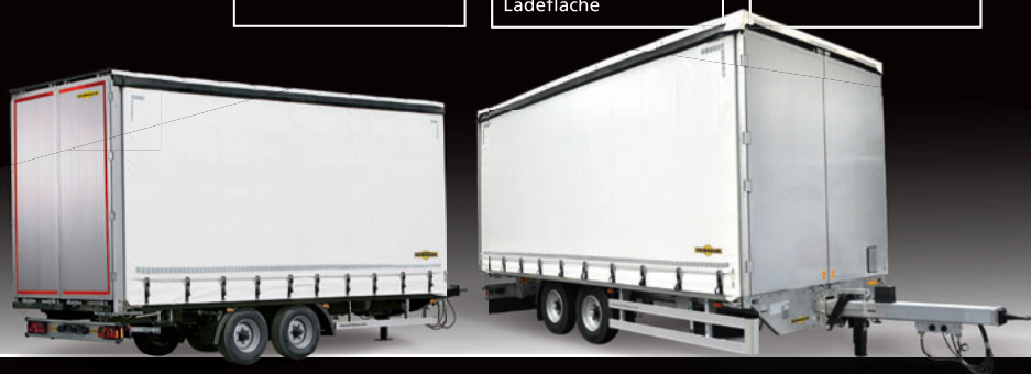
Curtainsider-Aufbau mit Schiebeplanen seitlich und Schiebendach zur Topbeladung
