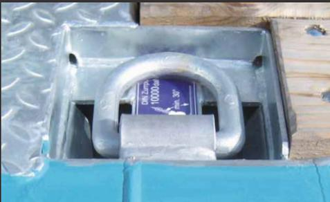
Zusätzlicher im Brückenboden versenkter Zurrpunkt
