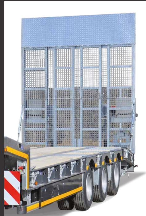
Stahlüberfahrwand über die gesamte Breite mit Gitterrostbelag
