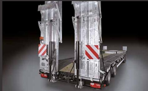
2-teilige hydraulische Rampen mit hydraulischer Seitenverschiebung
