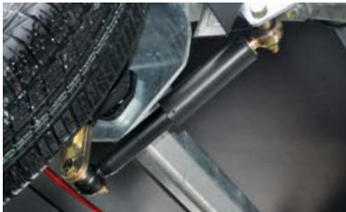
Radstoßdämpfer (montiert) inkl. 100 km/h Bestätigung
