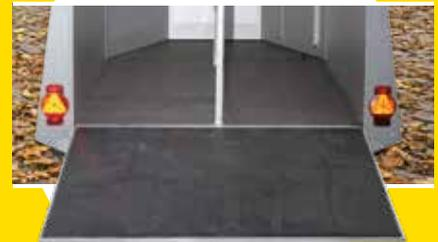
Oft werden Pferdeanhänger auf einer Wiese abgestellt. Die neblige und feuchte Lage greift auf Dauer den Anhängerboden an. Lassen Sie den Anhänger am besten auf einem asphaltierten Weg ruhen. Eine **Versiegelung mit Unterbodenwachs** kann zusätzlich den Boden schützen.
