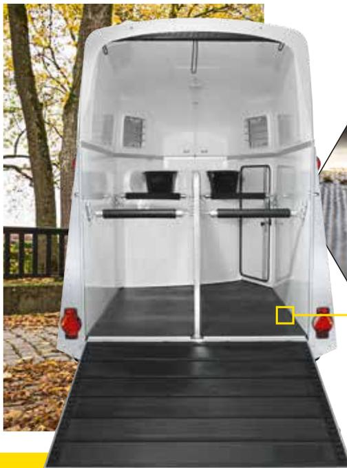
Die spezielle Beschichtung der Aluminiumplatten verhindert Oxidation, z.B durch Ammoniak aus den Fäkalien der Pferde. Dank seinem durchdachten Aufbau ist der AluBiComp Boden **unverrottbar und robust**.
