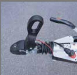
Sicherheitskupplung mit Spurstabilisierung
