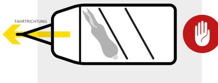
Die vordere Achse des Anhängers und die hintere Achse des Zugfahrzeugs werden zu stark beansprucht.
