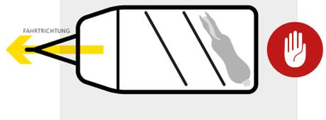
**Der Anhänger neigt nach hinten**, das Zugfahrzeug neigt nach vorne = die Stützlast ist zu niedrig bzw. negativ.
