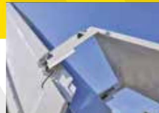
**Hydraulische Rückwandklappe (optional)**
